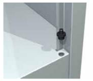
10. Вставить верхние оси в соответствующие отверстия крыши. Установить двери в следующей последовательности :
