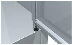
12. «Утопив» подпружиненный металлический наконечник верхней оси, завести дверь под верхнюю ось и совместить соответствующее отверстие в двери с осью до выщелкивания наконечника.
