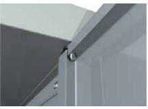
13. Для установки замка снять гайку и шайбу крепления корпуса. Вставить корпус замка в соответствующее отверстие двери и зафиксировать его с помощью гайки с шайбой.
